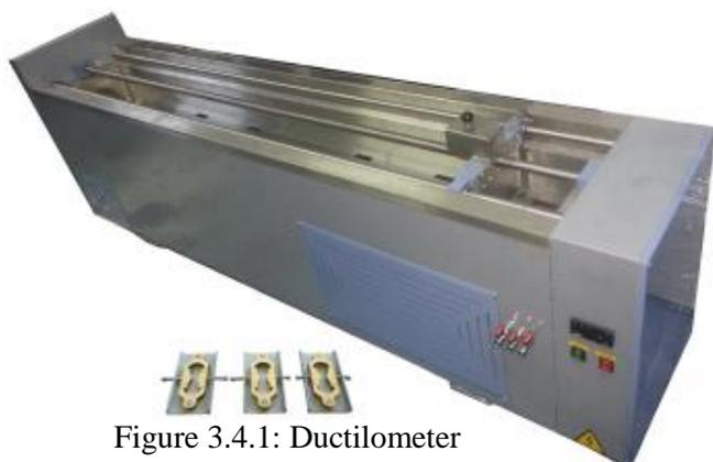
Figure 3.4.1: Ductilometer
